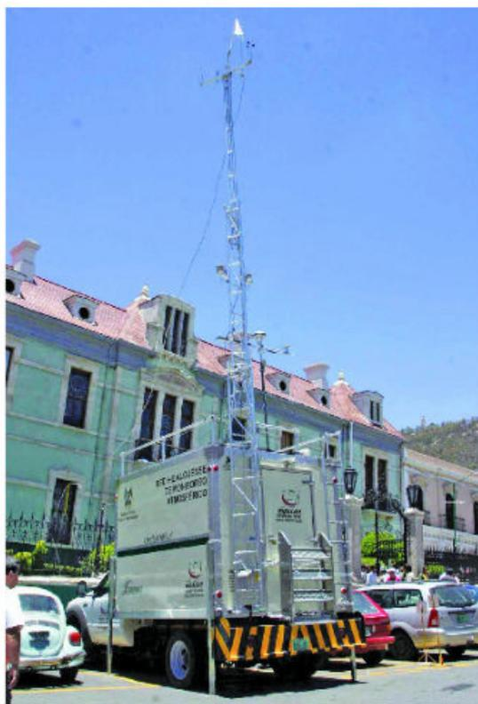
Figura 1.44 Estación móvil de monitoreo atmosférico.
