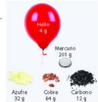
**Figura 3.46** Masa de una mol de algunas sustancias. Cada muestra contiene  $6.02 \times 10^{23}$  átomos.
