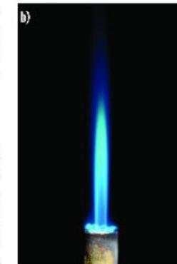
Figura 4.37 Flama producida por una combustión: a) incompleta (pobre en oxígeno), b) completa (rica en oxígeno).
