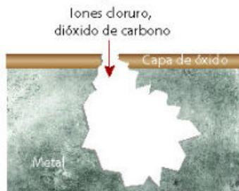
Figura 4.32 La capa de óxido que se forma en los metales espontáneamente sirve de protección al mismo, pero si se rompe, el metal se corroe con rapidez.
